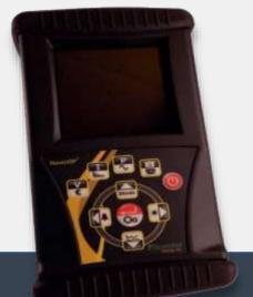
NanoVIP® TWO WF™ è un analizzatore della Qualità dell'energia portatile, compatto e potente per uso professionale; può essere utilizzato su reti monofase, bi-fase, trifase bilanciate, in bassa e media tensione.
